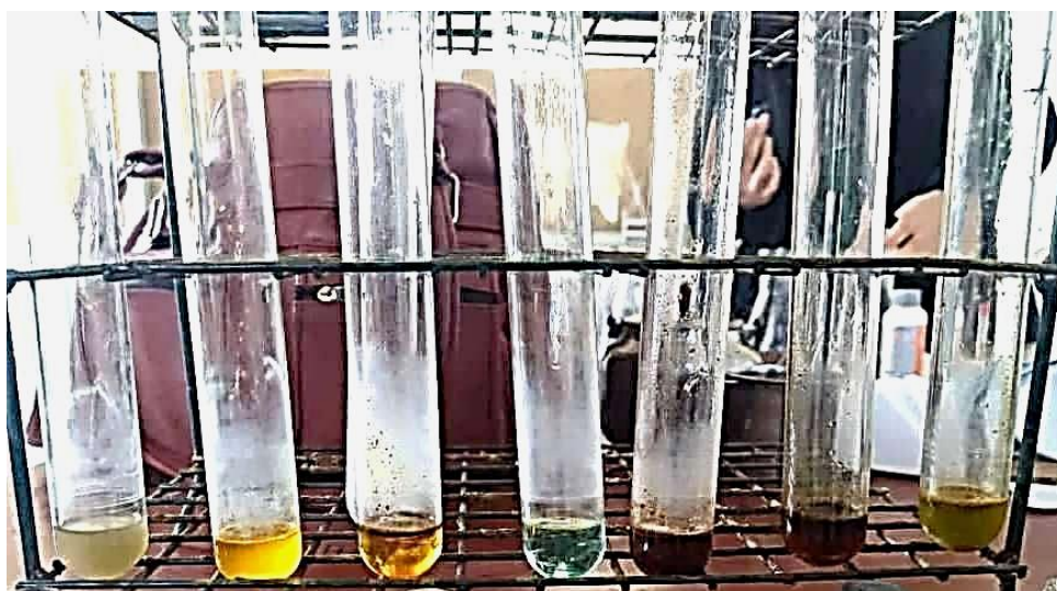
الشكل (a-2-2-IV): عينات الامتصاص الذري
