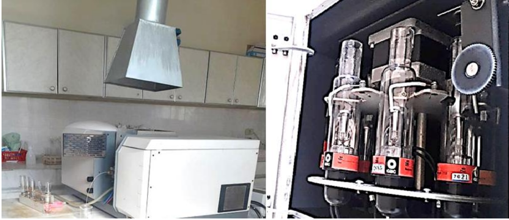
الشكل ( III-1-a ) : جهاز الامتصاص الذري في مركز البحوث الزراعية - حمص
