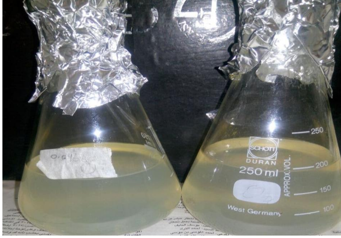
الشكل (III-8-2): بداية تشكل معقدات الفضة النانوية وفق التركيزين O_1 و O_2
