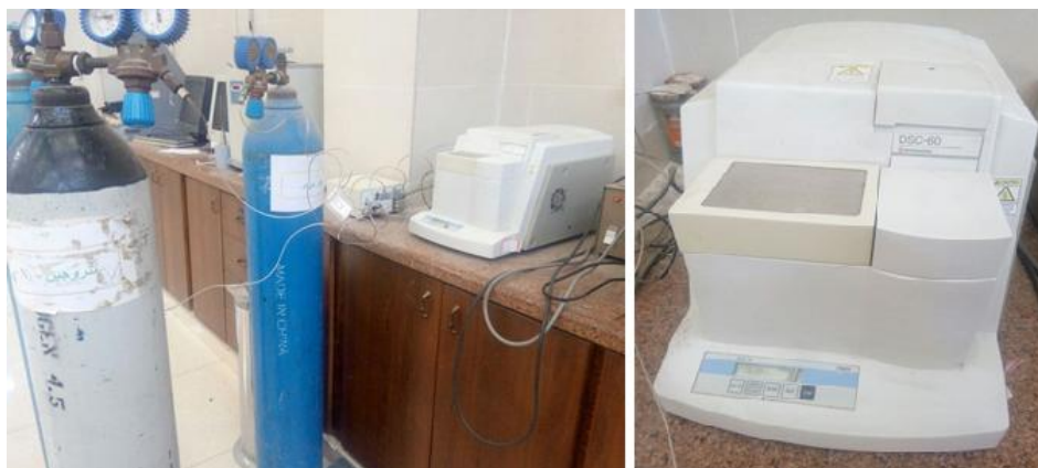
الشكل (c-1-III) : الماسح المسعري التفاضلي (DSC)
